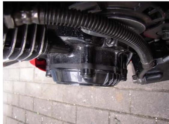
Bild 3: Die dicke Zündgebergehäusedichtung der XJR wurde beibehalten.
