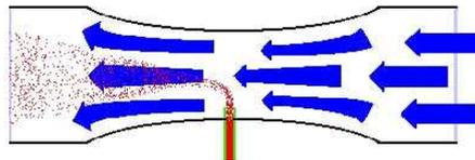
Wenn Luft (**blau**) durch das Rohr strömt und den engeren Bereich passiert, muß sie an dieser Stelle schneller strömen, als in den anderen Bereichen. Dadurch entsteht an der Engstelle ein Unterdruck (wie an der Oberseite einer Tragfläche). An der Engstelle ist ein kraftstoffgefülltes Röhrchen angebracht. Durch den Unterdruck im Venturirohr wird der Kraftstoff angesaugt und vom Luftstrom (**blau**) mitgerissen.
