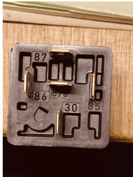
Als Relais kommt bei mir solch ein Bosch KFZ Relais *mit 30A* zum Einsatz.
