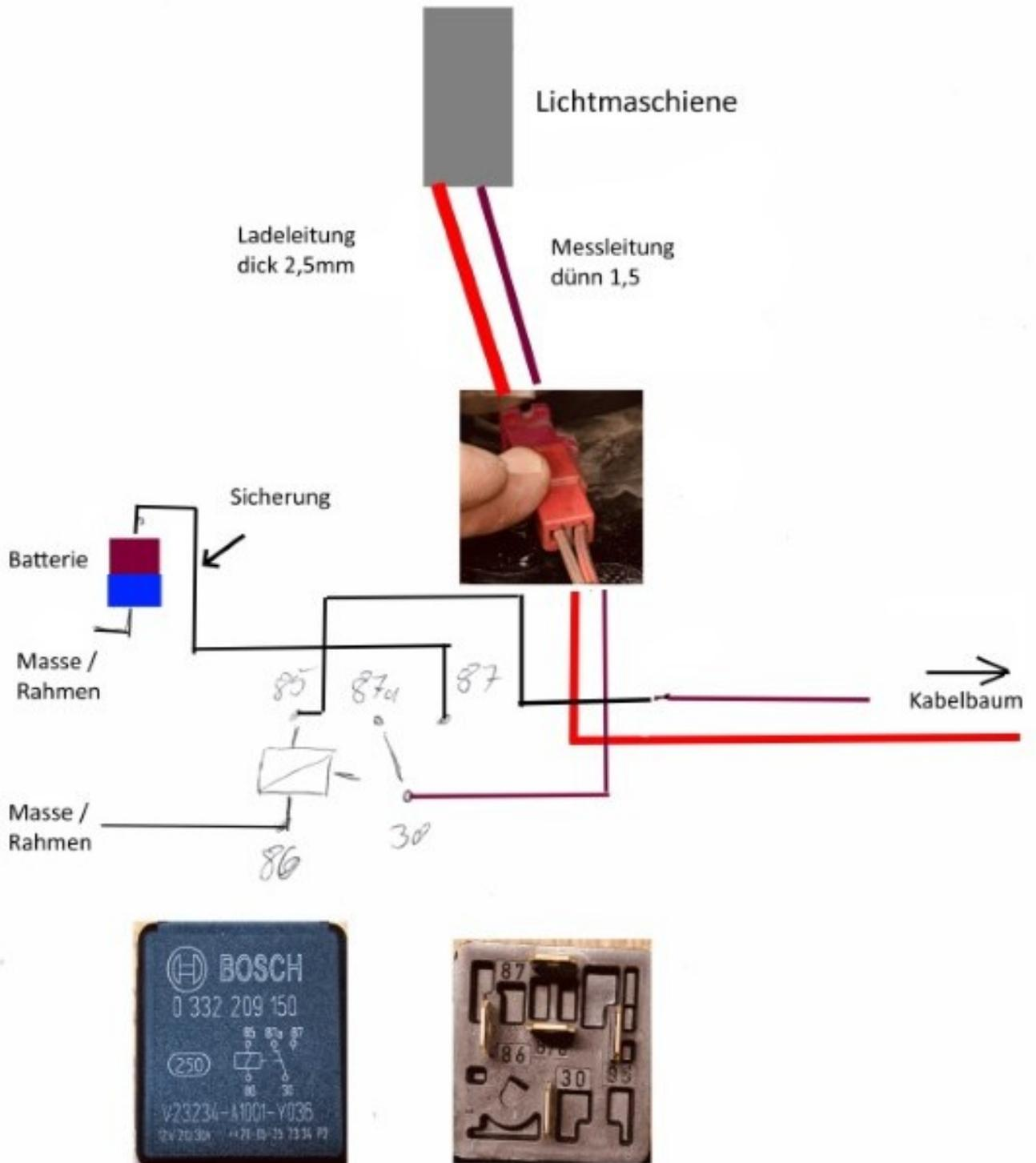
Dünnes Kabel an der Kabelbaum Seite ca. 4cm hinterm Stecker trennen. Das Ende vom Kabelbaum 85, 86 kommt an den Rahmen (auf Masse).
