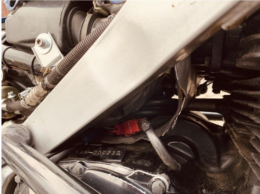
An diesem Stecker sind zwei Kabel. Ein Dickeres 2,5mm<sup>2</sup> (rot) und ein Dünnes 1,5mm<sup>2</sup> (bräunlich ?) Das Dünne ist unsere Meßleitung.
