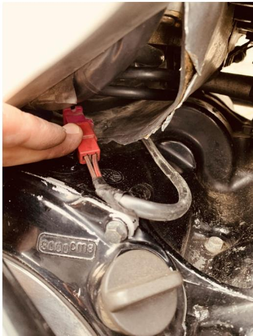
Einfacher Test - den Plus Pol der Batterie mit einem Kabel in den Stecker rein prokeln und die Ladespannung messen.
