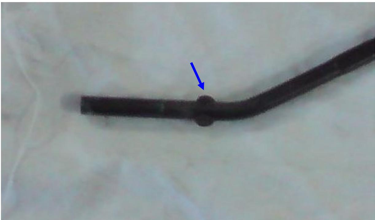
Diese "Verdickung" verhindert ein Durch-Rutschen durch eine der beiden Abstandshülsen im Gummi-Einsatz der Tank-Befestigung vorne.
